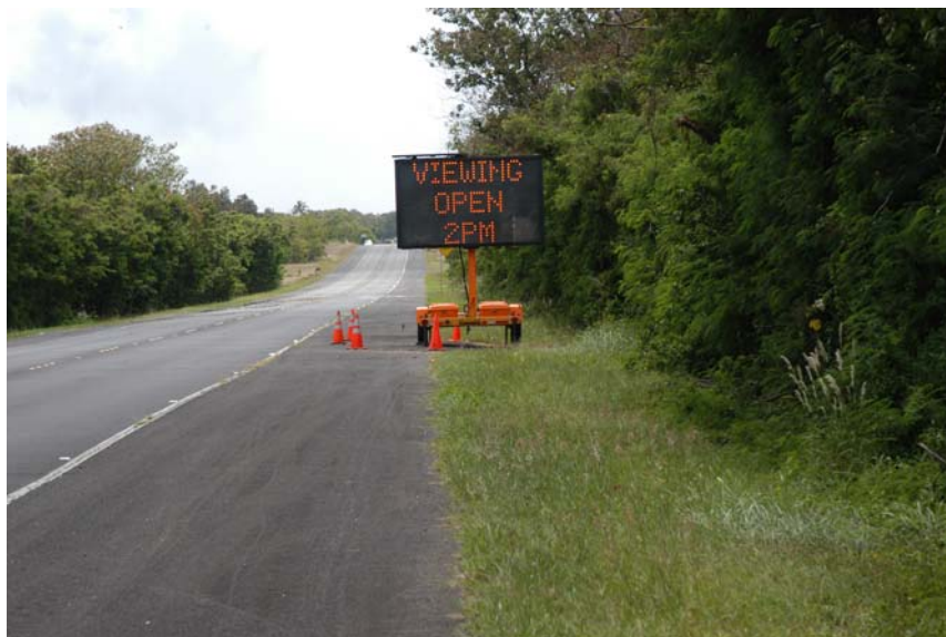
図 31 道路規制情報を流す仮設の電光掲示。電源は太陽電池。
